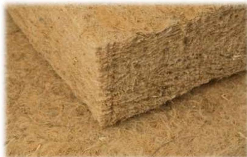
Lorsque la façade bois à bardage ventilé est protégée par un écran thermique a minima A2-s3, d0, il est admis de mettre en œuvre des isolants bio-sourcés derrière l'écran thermique à condition que le revêtement du bardage ventilé présente lui-même une performance de réaction au feu à minima B-s3, d0.
